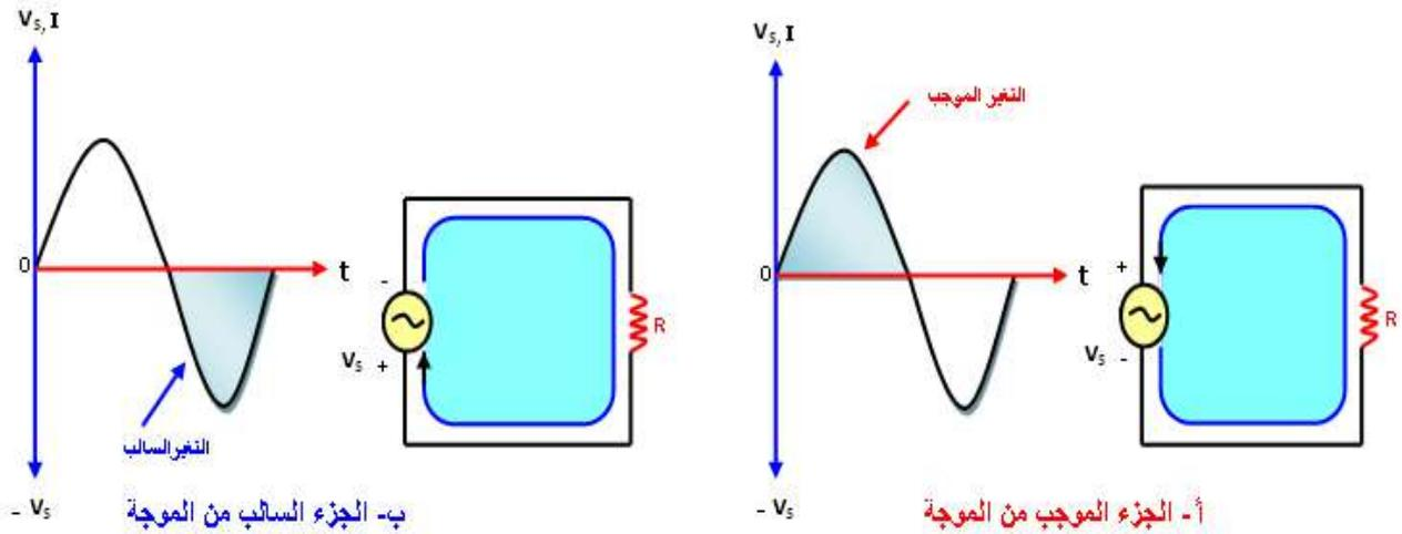
شكل 1-7 شكل الموجة المتولدة من مولدات التيار المتناوب هي موجة جيبية
