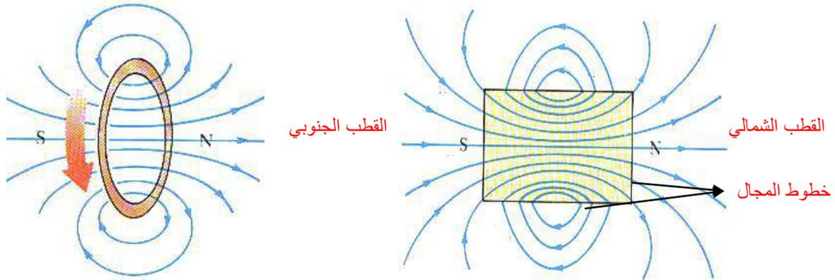
أ- خطوط المجال المغناطيسي لمغناطيس دائم ب- خطوط المجال المغناطيسي لحلقة يمر فيها تيار
