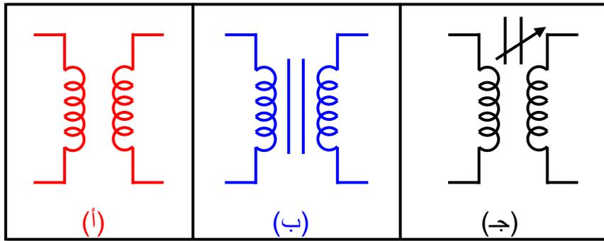
شكل 2-11 رموز الأنواع الأساسية للمحولات (أ) تمثل المحول ذو القلب الهوائي (ب) تمثل المحول ذو القلب الحديدي (ج) تمثل المحول ذو القلب المتغير.
