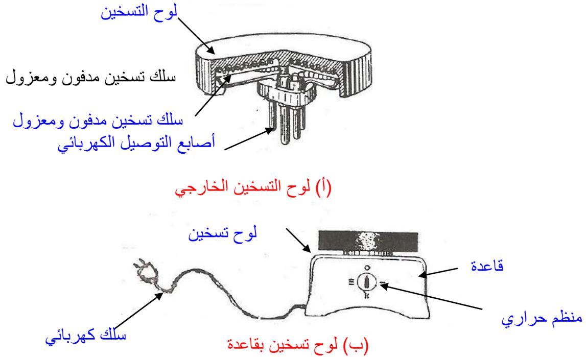
شكل 5-12 الواح التسخين الكهربائية
