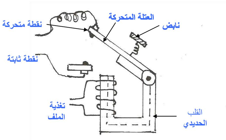
الشكل 10-12 مخطط يبين مبدأ عمل المرحل أو الموصل الهوائي
