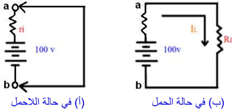
شكل 5-7 طريقة قياس المقاومة الداخلية للمصدر
