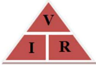
$$\text{شدة التيار} = \frac{\text{فرق الجهد}}{\text{المقاومة}}$$
