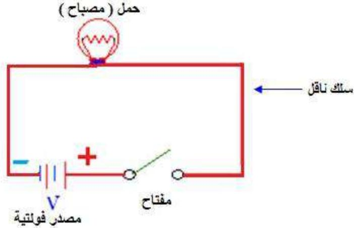
شكل 9-1 الدائرة الكهربائية
