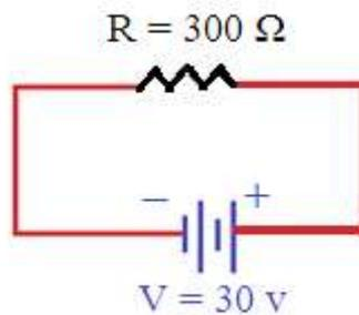
$$\text{شدة التيار} = \frac{\text{فرق الجهد}}{\text{المقاومة}}$$
