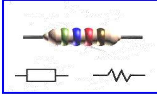
شكل 5-1 رمز المقاومة في الدوائر الكهربائية
