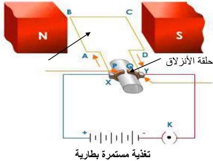
الشكل 7-12 مخطط المحرك الكهربائي البسيط ذو التيار المستمر
