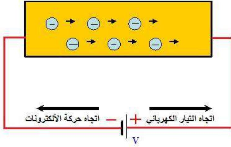
شكل 4-1 اتجاه حركة الإلكترونات واتجاه التيار الكهربائي
