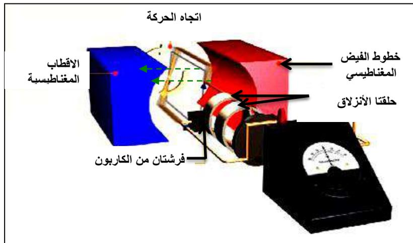
الشكل 8-12 مخطط المحرك الكهربائي البسيط ذو التيار المتناوب
