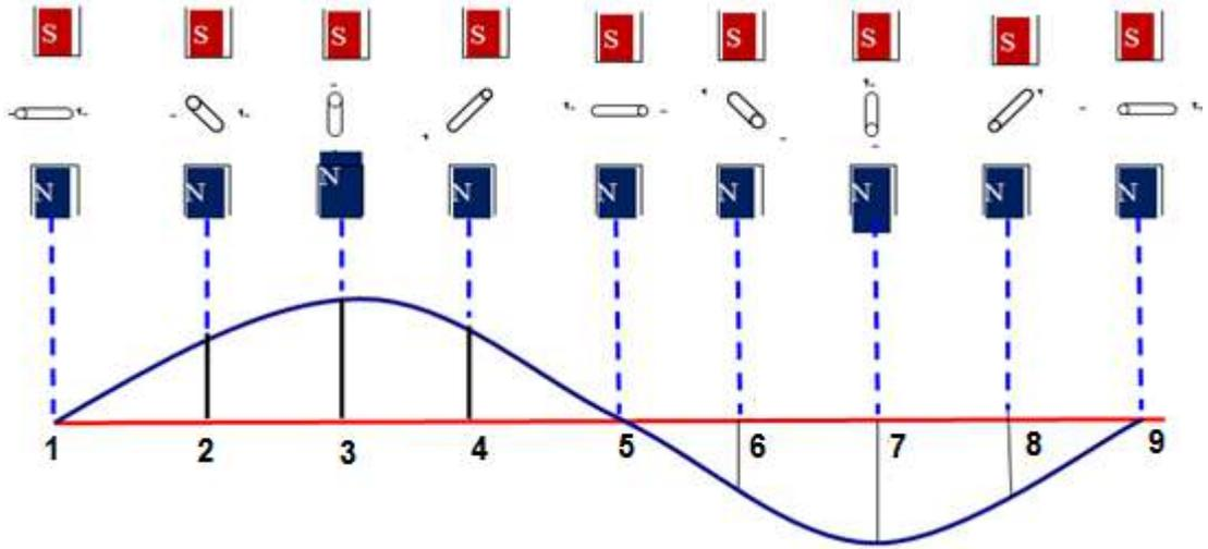
الشكل (7-4) عمل المولد الكهربائي
